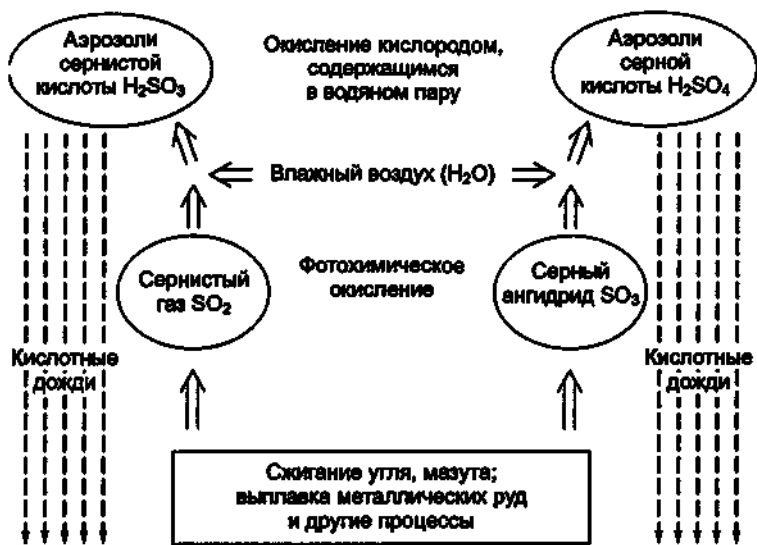
Рис. 8.21. Последовательность событий при формировании кислотных осадков
